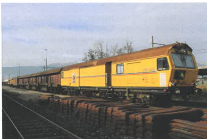
Train meuleur de rails (Scheuchzer S.A.)
